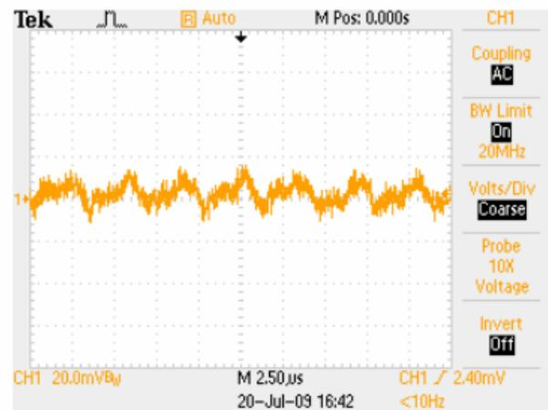
纹波与噪声: 输入 12V, 10A 负载, 5~20MHz 带宽
