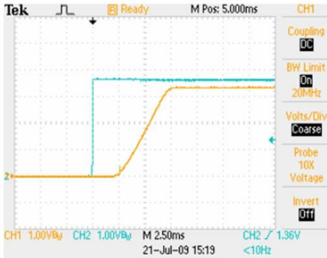
用 ON/OFF 控制上电过程，控制压 5V
