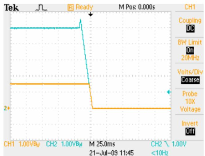
用 EasyTrack™ 控制下电过程, 控制压 5V, 负载 10A
