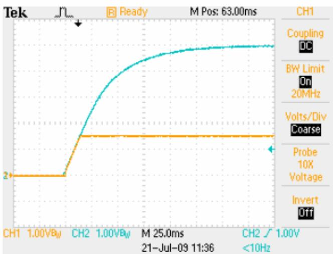
用 EasyTrack™ 控制上电过程, 控制压 5V, 负载 10A
