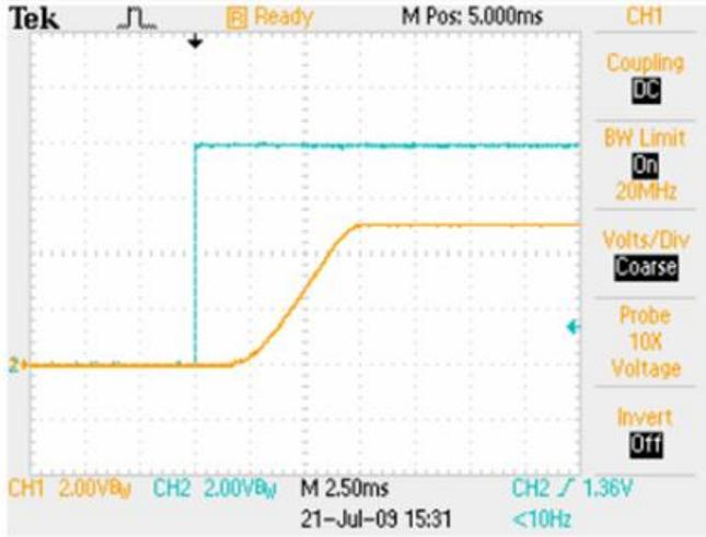
用 ON/OFF 控制上电过程, 控制压 12V, 负载 10A
