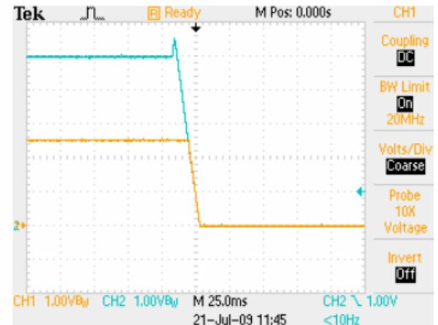
用 EasyTrack™ 控制下电过程, 控制压 5V, 负载 10A
