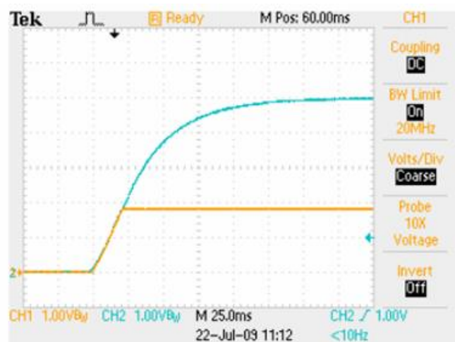
启动波形: 输入 5V, 负载 6A 黄色: 输出电压; 蓝色: 输入电压
