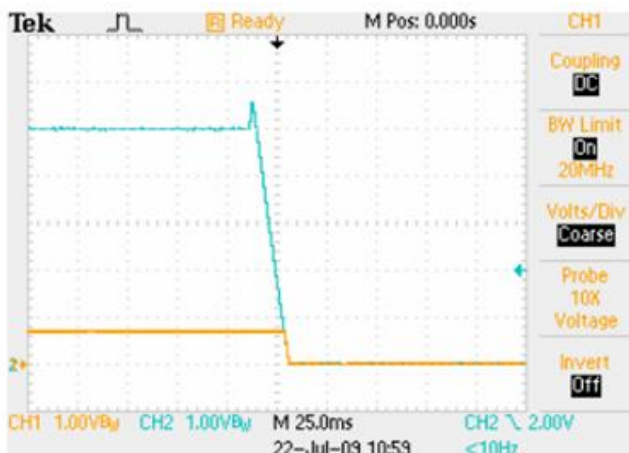
输出短路电流波形, 输入电压 5V
