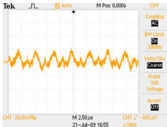
纹波与噪声: 输入 12V, 6A 负载, 5~20MHz 带宽
