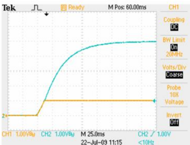
启动波形: 输入 5V, 负载 6A 黄色: 输出电压; 蓝色: 输入电压
